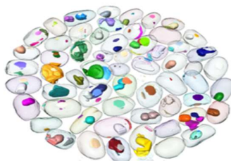
Figure 1. Semences de féverole reconstituées après imagerie tomographique en RX 3D, avec identification en couleur des dégâts causés par des insectes – Projet PeaMUST.
